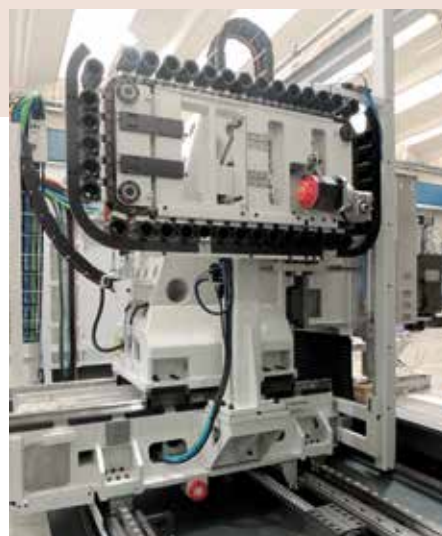
■ Magazzino utensili collegato al montante, riduce i tempi di cambio utensile. Tool Magazine connected to the moving column, short tool change time.
